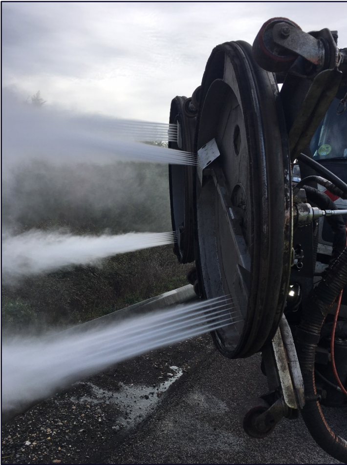
Detalles de flujo de agua a muy alta presión (imagen superior izda.) y toma de datos de CRT con péndulo TRRL (imagen superior dcha.)
